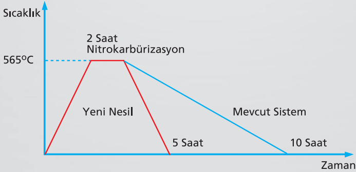
Ekstrüzyon Kalıplarında Mevcut Sistemlere Göre Zaman Çevrimi Karşılaştırılması
